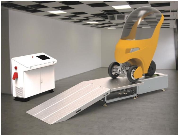
Das Prüfstandsystem ist modular aufgebaut und kann bequem mit einem Handhubwagen verschoben werden. Die Leistungselektronik ist für zwei Prüfrollenmodule ausgelegt und kann diese unabhängig betreiben. Dadurch steht der ZHAW ein vielseitiges Werkzeug für den Weg in die Zukunft zur Verfügung.
