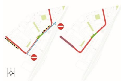
Die langfristige Bestvariante (links) zeichnet sich durch ein Einbahn- Regime auf der Strasse Zur Kesselschmiede aus. Beide Varianten sind Tempo-30- und Begegnungszonen.
