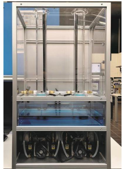
Demonstrationsobjekt mit zwei kommunizierenden Wassertanks, zwei Wasserpumpen, vier Magnetschaltventilen, einem Wasserreservoir und einer Steuerungsbox. Die Füllstände der beiden Wassertanks können getrennt voneinander eingestellt und geregelt werden.
