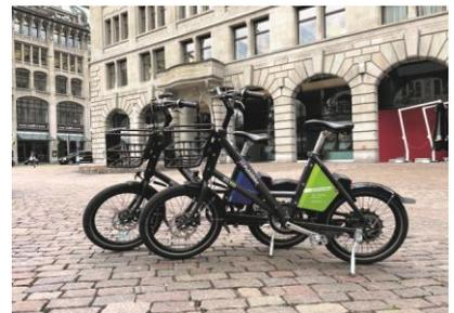
Die beiden auf dem öffentlichen PubliBike-Netz eingesetzten E-Bikes 500709 und 500849. Die RHT-Messgeräte sind an den weissen RHT-Sensor-Modul-Gehäusen (Steuerhorn) sowie am roten Bestandteil des Akkukabels zu erkennen.
