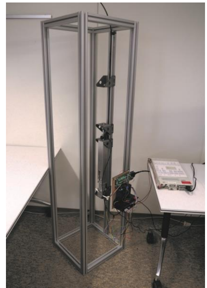
Prüfstand von Cyltronic mit Zylinder, Steuerung und Speisung
