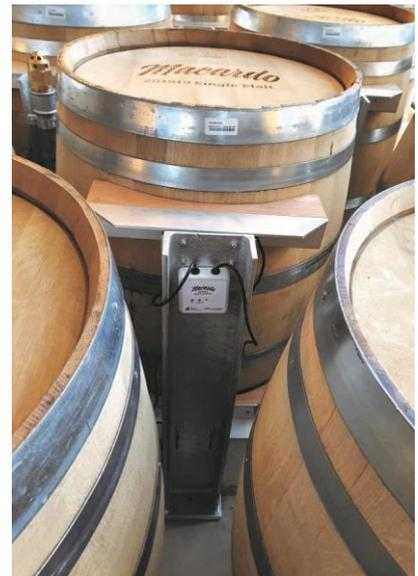
Im Bild ist ein installiertes Sensormodul zu sehen. Montiert wird es mit Magneten unterhalb des Fasses.
