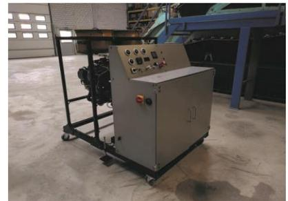
Prüfstand für den Lycoming IO-360-L2A Motor welcher, nach Beendigung der Arbeiten am Prüfgestell montiert ist. In der Graphik ersichtlich, das Steuerpult des Prüfstands mit der benutzerfreundlichen Bedieneinheit. Dahinter befindet sich der Motor.
