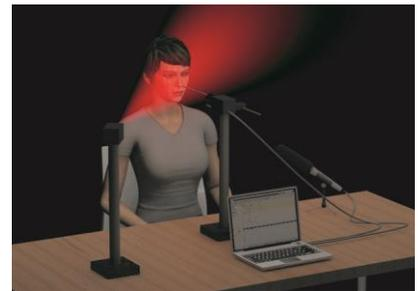
Eine LED Optik projiziert strukturiertes Licht auf das Gesicht einer Person. Mit einer Hochgeschwindigkeitskamera und einem Mikrofon wurden Aufnahmen einer sprechenden Person gemacht, welche nachfolgend in MATLAB bearbeitet und analysiert wurden.
