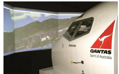
Aussenansicht des B 737-Flugsimulators. Die Aussensicht wird von drei grossen Beamern auf die Leinwände projiziert. Dies ergibt ein Sichtfeld von fast 180°. Der B737 Flugsimulator basiert auf einem echten Flugzeugvorderteil der United Airline.
