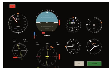
Das Captain und First Officer Panel ist Hauptbestandteil dieser Arbeit. Die Panel befinden sich direkt vor dem Piloten bzw. Co-Piloten und zeigen die wichtigsten Instrumente des virtuellen Flugzeugs auf einem 24 Zoll LCD-Monitor an.
