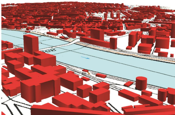
Ausschnitt aus swissBUILDINGS3D (Bundesamt für Landestopografie); Gebäudekörper von Basel (Rheinhafen), die Pixelkarte (PK25) und im Hintergrund das digitale Höhenmodell (DHM25). Die Gebäudekörper dienen als Basis für die Datenerfassung und die Berechnungen der Gebäudespezifikationen.
