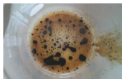
Die durch die Pyrolyse erhaltene Flüssigkeit besteht aus einer wässrigen und öligen Phase. Die Öle können als Treibstoff verwendet werden. In dieser Arbeit wurde jedoch versucht die Ölproduktion zu reduzieren, um die Ausbeute des Synthesegases zu erhöhen.
