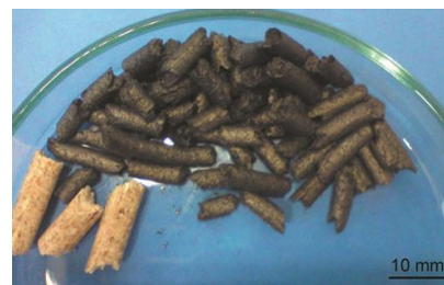
In der obigen Abbildung werden die Holzpellets vor und nach der Pyrolyse gezeigt. Die Pellets werden durch die Pyrolyse kleiner und leichter, und bestehen danach fast ausschliesslich aus Kohlenstoff. Die restlichen Bestandteile wurden zu Ölen und Gas zersetzt.
