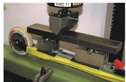
Der im Feldtest gemessene Rollski wurde unter der Prüfmaschine mit einer Stempelvorrichtung belastet.
