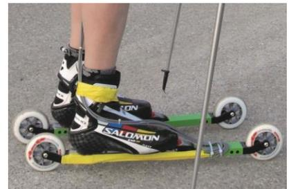
Im oberen Bild ist ein mit Dehnungsmessstreifen bestückter Rollski beim Feldtest zu sehen.
