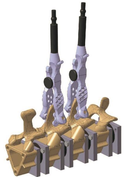
Das adaptierte Klemmensystem ermöglicht eine optimale Verbindung zu Dornfortsätzen der lumbalen Wirbelsäule.
