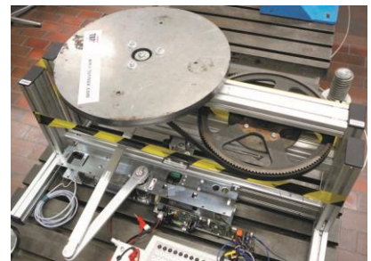
Testaufbau eines Türantriebes mit dem Trägheitsmoment einer Tür
