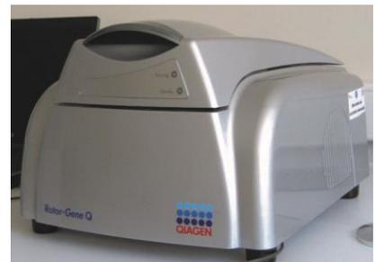
Rotor-Gene Q Thermocycler. Mit diesem Gerät lassen sich bestimmte DNA-Sequenzen innerhalb einer Probe identifizieren.
