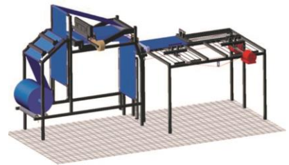
Ansicht der Folienhandhabung der Abfüllmaschinen für Pilzsubstrat
