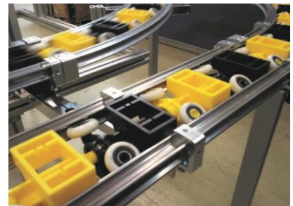
Abb.1: Prototyp der Kettenkörper mit aufgepressten Förderrollen im Betrieb. Die Förderrollen laufen in entsprechenden Führungsprofilen.
