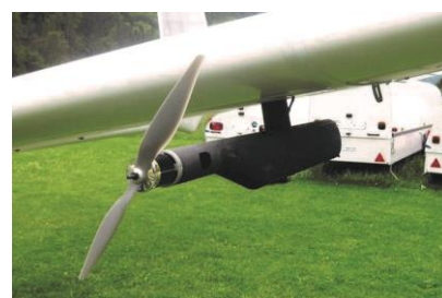
Detailansicht des montierten E-Pod am Flügel mit Elektromotor und Handloch in der Verschalung
