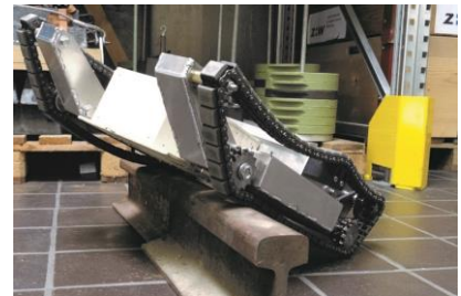
EOD in Fahrt bei Überquerung einer Eisenbahnschiene. Der Roboter kann Hindernisse überwinden, die gleich hoch sind wie der Roboter.
