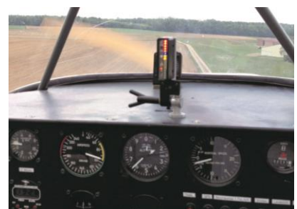
Die im Messflugzeug Rans-Coyote installierte Angle of Attack-Anzeige während dem Anflug auf Ferrette (FR)
