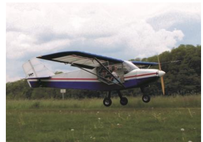
Das Messflugzeug Rans-Coyote mit Angle of Attack-Sonde (r) und Air Data Boom (l) in Ferrette (FR)
