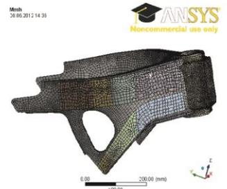
Beispiele von CFK-Versteifungen, die an den Rahmen geklebt sind. Die Teile sind vernetzt.
