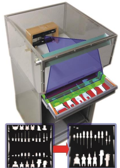
Kinect und Zeilensensor sind im Demonstrator übereinander angeordnet. Das Sichtfeld der Kinect ist grün, die Infrarot-Lichtebene des Zeilensensors blau eingezeichnet. Die mit dem Zeilensensor aufgenommenen Daten (unten links) werden mit Hilfe der Positionscodierung auf dem Schubladenrand richtig zu einem Bild (unten rechts) zusammengefügt.
