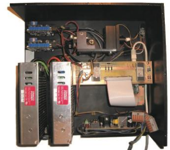
Hardwareaufbau des Laserprojektors mit neuem Prozessor
