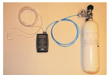
Das EDS-O2D1-Gerät, wie es während dieser Arbeit verwendet wurde, mit einer 2-Liter-Sauerstoffflasche (200 bar)
