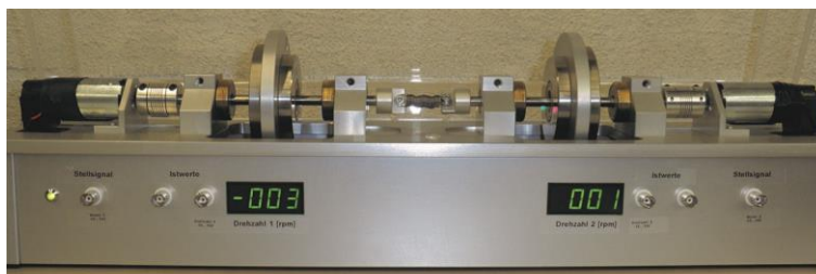
Bild des Schwungmassenmodelles und Diagramm der konzentrierten Parameter
