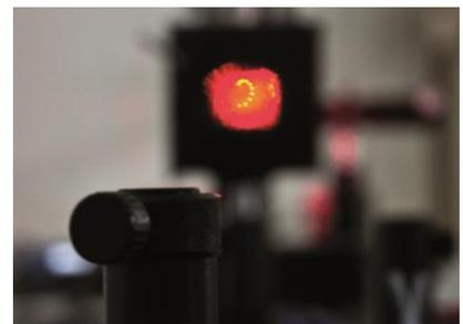
Fotoaufnahme einer durch ein synthetisches Hologramm erzeugten Spirale im Raum. Die Distanz zum SLM beträgt 1 m und zur Spirale 0.3 m.
