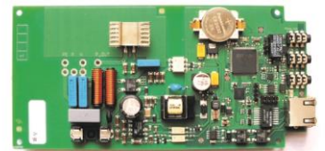
Die Umsetzung der Software in C erfolgte auf einer speziellen Hardware mit modernem ARM 32 Bit Mikrocontroller.
