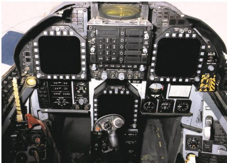
Cockpit des F/A-18 Hornet Kampfflugzeuges mit dem evaluierten Autopilotensystem in der Bildmitte über dem mittleren Display
