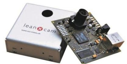
Die leanXcam gehört zu den sogenannten intelligenten Kameras. Dieser Kameratyp ist mit einem Prozessor ausgestattet, auf dem sich Bildberechnungen durchführen lassen.
