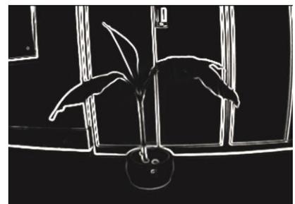
Kantendetektion, die mit der leanXcam und dem entwickelten Framework berechnet wurde.
