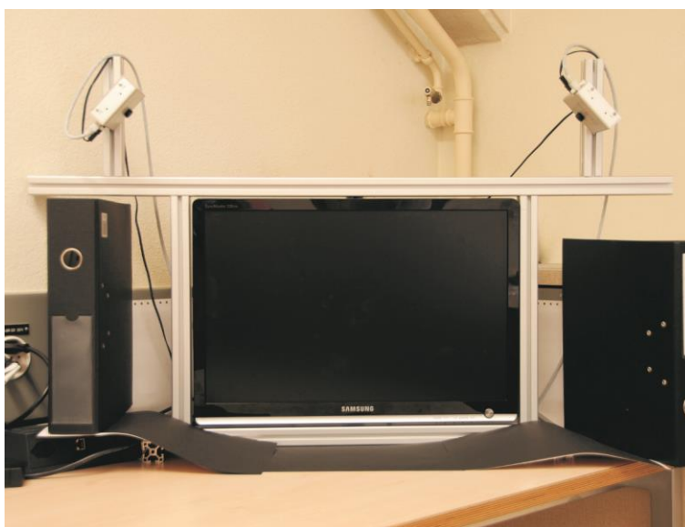
Versuchsaufbau eines optischen Touchscreens, welcher mit zwei Kameras für die Berührungserkennung arbeitet.
