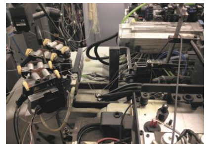
Die neu entwickelte Fadenbremse mit Kraftsensor.
