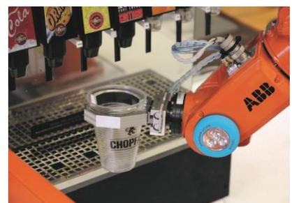
Roboter beim Abfüllen eines Getränks.
