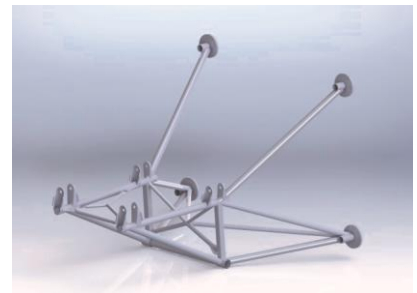
CAD-Modell des Motorträgers, aus Flächenelementen aufgebaut.
