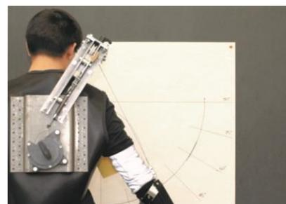
Der mechanische Prototyp unterstützt die Abduktion mit einem Federantrieb.
