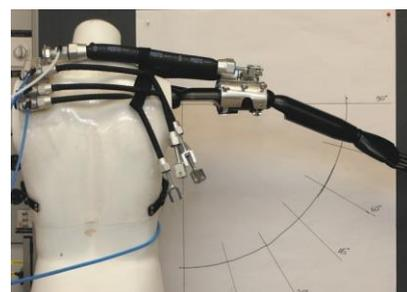
Pneumatischer Prototyp führt Abduktion an einer Schaufensterpuppe aus.
