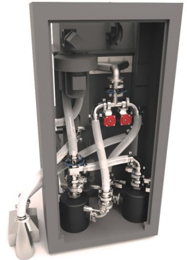
Das entwickelte Doppelfiltersystem mit zwei eingesetzten „MANN-Filtern“ mit automatischer Umschaltung beim eingestellten maximalen Differenzdruck.
