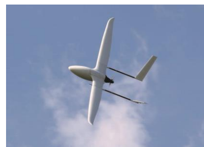
Der UMARS-Prototyp mit dem nicht verbundenen Leitwerk beim Erstflug.
