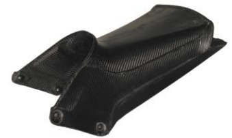
Hergestelltes Rahmenheck mit optimiertem Lay-up.
