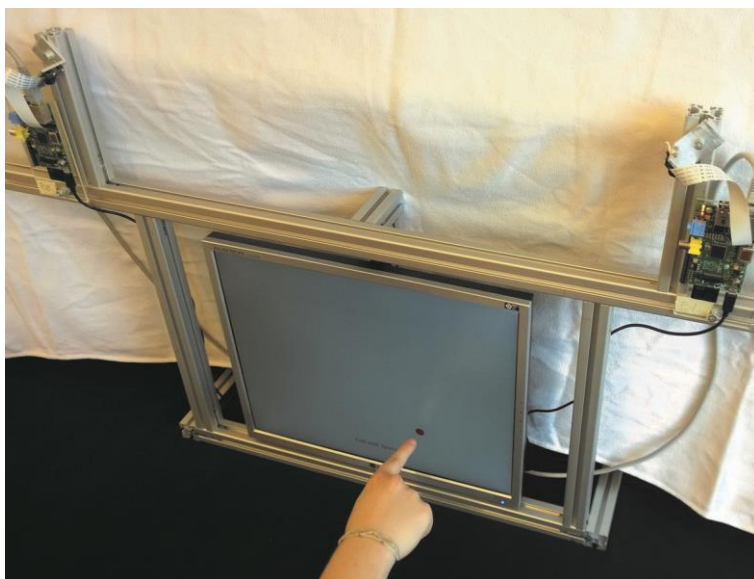
Beim Testaufbau sind in den Ecken zwei Raspberry Pi Systeme mit je einem Kamera-Modul erkennbar. Auf dem Monitor wird unsere Fingertracking-Applikation angezeigt, die die Funktionalität des virtuellen Touchscreens demonstriert.
