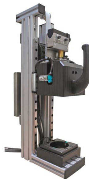
Dieses Bild zeigt die in dieser Arbeit erstellte Prüfvorrichtung. Mit deren Hilfe kann die Richtigkeit der Montage von Rückschlagventilen zu Wasserfiltern geprüft werden. Die Prüfung erfolgt mit taktilen Schaltern, induktiven Sensoren und einer Messung von der Intensität einer integrierten infraroten Lichtquelle.
