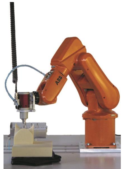
Roboter mit Fräseinheit bei der Bearbeitung der Schmetterlingsfläche.
