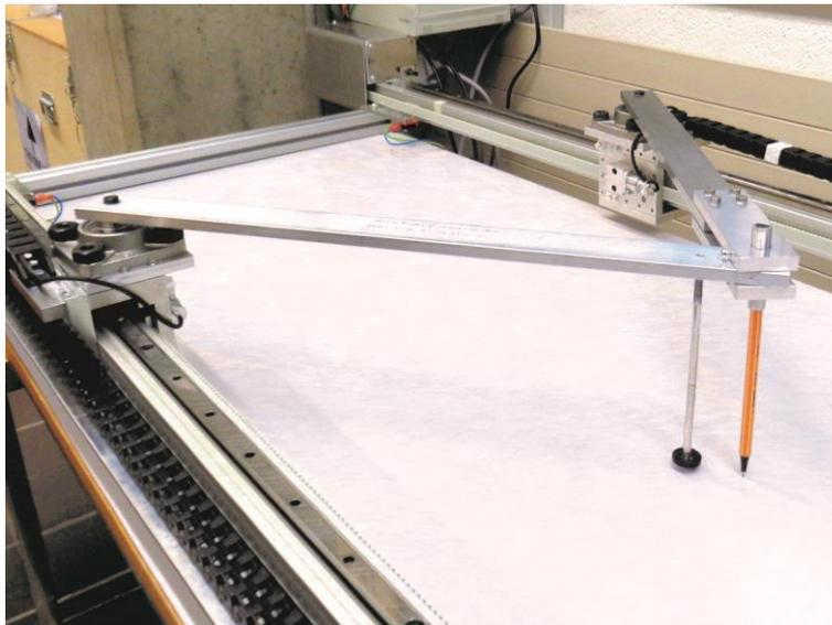
Prototyp des Parallelkinematik Systems. Links und rechts die beiden Linearachsen darüber montiert die Scherenarmkonstruktion. Der eingespannte Stift dient der Aufzeichnung des gefahrenen Polygons.
