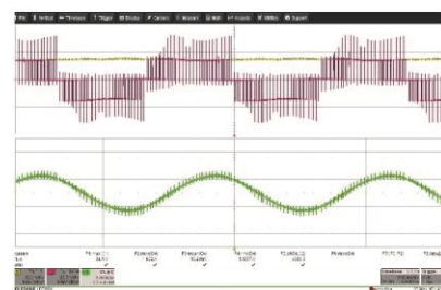
Schaltmuster am Ausgang: Ausgangsspannung mit den drei möglichen Pegeln (oben) und Strom in induktiver Last (unten)
