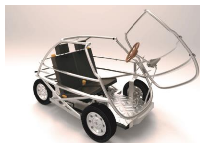
Ansicht ohne Verschalung bei geöffneter Tür (mit Chassis)
