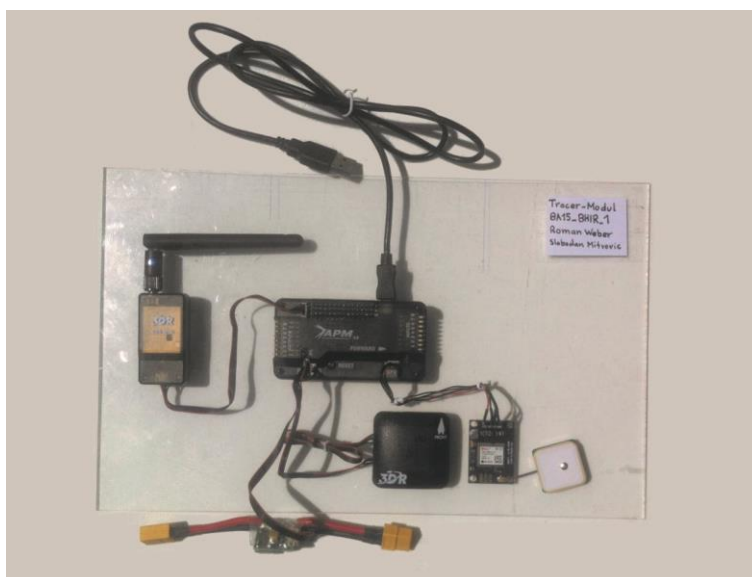
Entwickeltes Tracer-Modul; beinhaltet: Microcontroller, Telemetrie-Modul, 2x GPS- Modul
