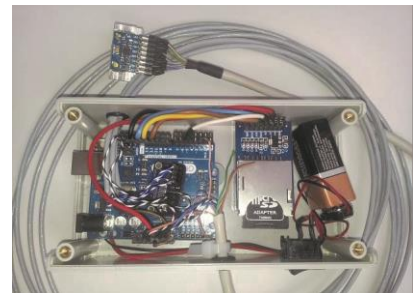
Autonom arbeitende Mess-Box inkl. SD-Karte, vier DMS-Anschlüssen und einem Anschluss für den Beschleunigungssensor
