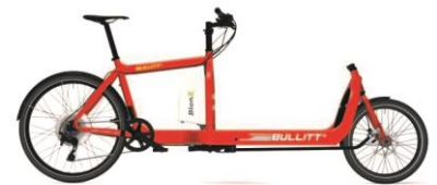
E-Cargobike Bullitt der Firma Larry vs Harry aus Dänemark. Mit dem E-Bullitt lassen sich bis zu 80 Kilogramm Ware transportieren. Das E-Bullitt eignet sich bestens für den Einsatz im Wirtschaftsverkehr.
