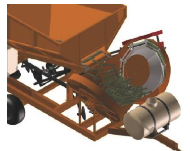
Die ungeordneten Stecklinge werden vom Tank in die Separationseinheit und anschliessend zur Setzeinheit transportiert.
