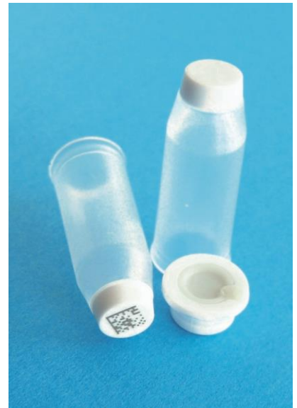
Serienprototyp des Treff High Pressure Tubes. Er besteht aus einem transparenten Tube mit weisser Spitze, auf der ein DataMatrix-Code aufgelasert ist. Der bis 5 bar druckdichte Deckel verfügt über eine durchstechbare, weiche Membran. Beide Teile werden im Mehrkomponenten-Spritzgussverfahren auf topmodernen Maschinen hergestellt.
