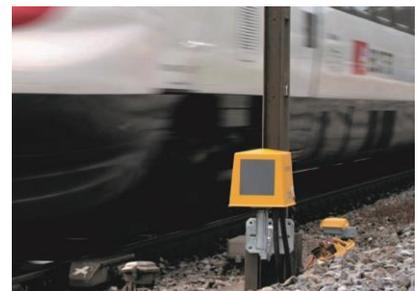
Die MiniLEU (Lineside Electronic Unit) erhält Signale und konvertiert diese in ETCS-Datentelegramme und ist in der Schweiz bereits im operativen Einsatz.
