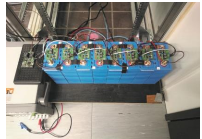
Li-Ion-Akkupack, ausgerüstet mit dem neu entwickelten aktiven Batteriemanagementsystem
